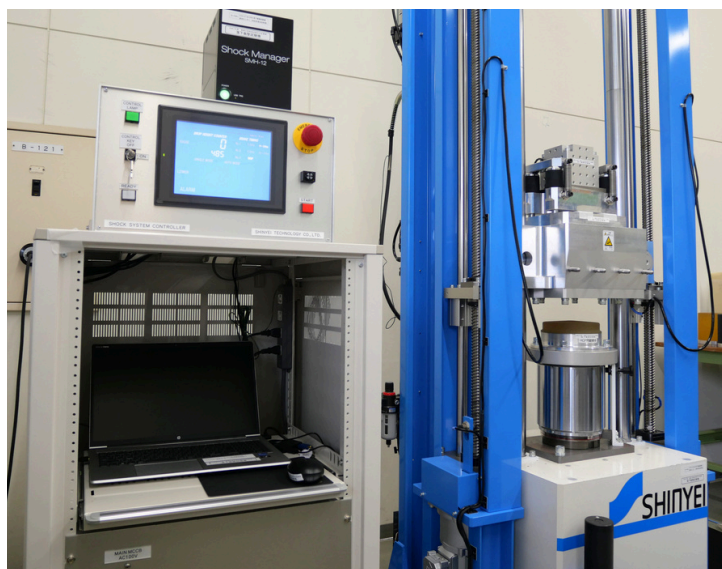
富山県産業技術研究開発センター 機械電子研究所内 衝撃試験機MDST-300
