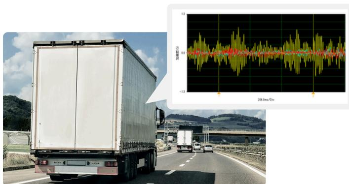
輸送環境記録計で計測された振動加速度波形のイメージ
