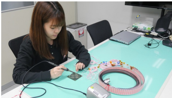
供試品のハーネス接続作業
