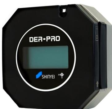
輸送環境記録計 DER-PRO は輸送時に発生する3軸加速度と温湿度の計測を行うデータロガーです。SDカードに大容量データを記録でき、外部バッテリーBOX(オプション)にて長期輸送にも対応します。計測データは専用ソフトウェアにて、PSD・ヒストグラム・PSD合成のデータ解析が行えます。
