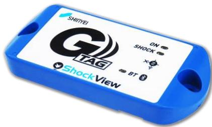
3軸衝撃センサを搭載した小型記録計で、製品の物流過程で発生する落下衝撃事象の記録や、包装落下試験で内容品に発生する衝撃加速度を計測する目的に利用できます
