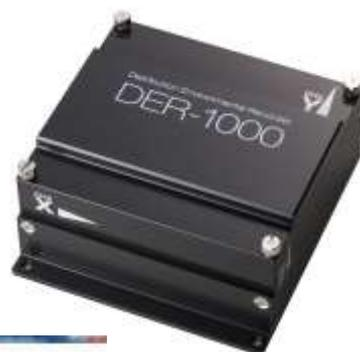
輸送環境記録計 DER-1000 は輸送時に発生する3軸加速度と温湿度の計測を行うデータロガーです。1GBの大容量メモリを搭載し、最長100日間の計測を実現しました。計測データは専用ソフトウェアにて、落下高さ・PSD・ヒストグラム・輸送診断・PSD合成の多様な解析が行えます。また用途に応じたバージョンを選択できます。
