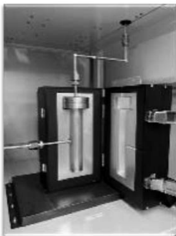
図22：微量水分発生装置中の拡散管
